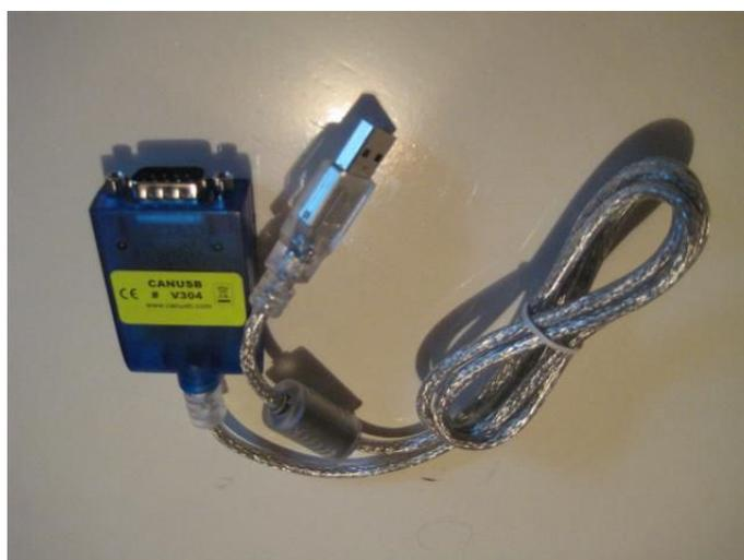
Es gibt auch noch andere Adapter für den CAN-Bus, die man an den PC anschließen kann, dazu auch Anleitungen zum Selbstbau für die ganz Verwegenen. Diese Adapter werden hier nicht behandelt, da die Software T5Suite mit dem CANUSB sozusagen „out of the box“ funktioniert. Verwendet man einen anderen Adapter, kann also noch zusätzlicher Aufwand nötig sein, um das Ganze zum Laufen zu bringen.
